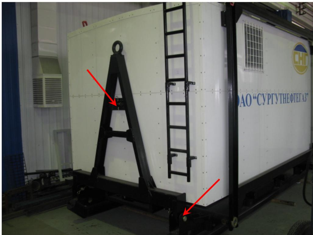
**Рис. 27 Место крепления тягово-цепного устройства**
