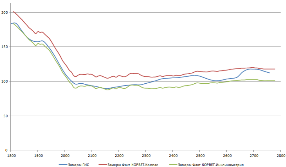
Рисунок 2 – График изменения Азимута с увеличением забоя скважины
